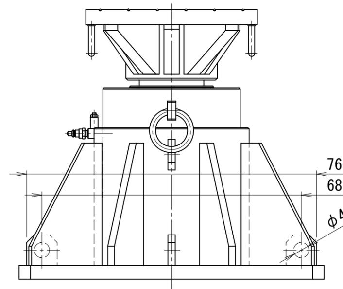
※) 球面回転ヘッドの為、無負荷ジャッキ作動時にヘッドが急に傾く場合があります。必要に応じて搭載物の転倒防止を行ってください。
