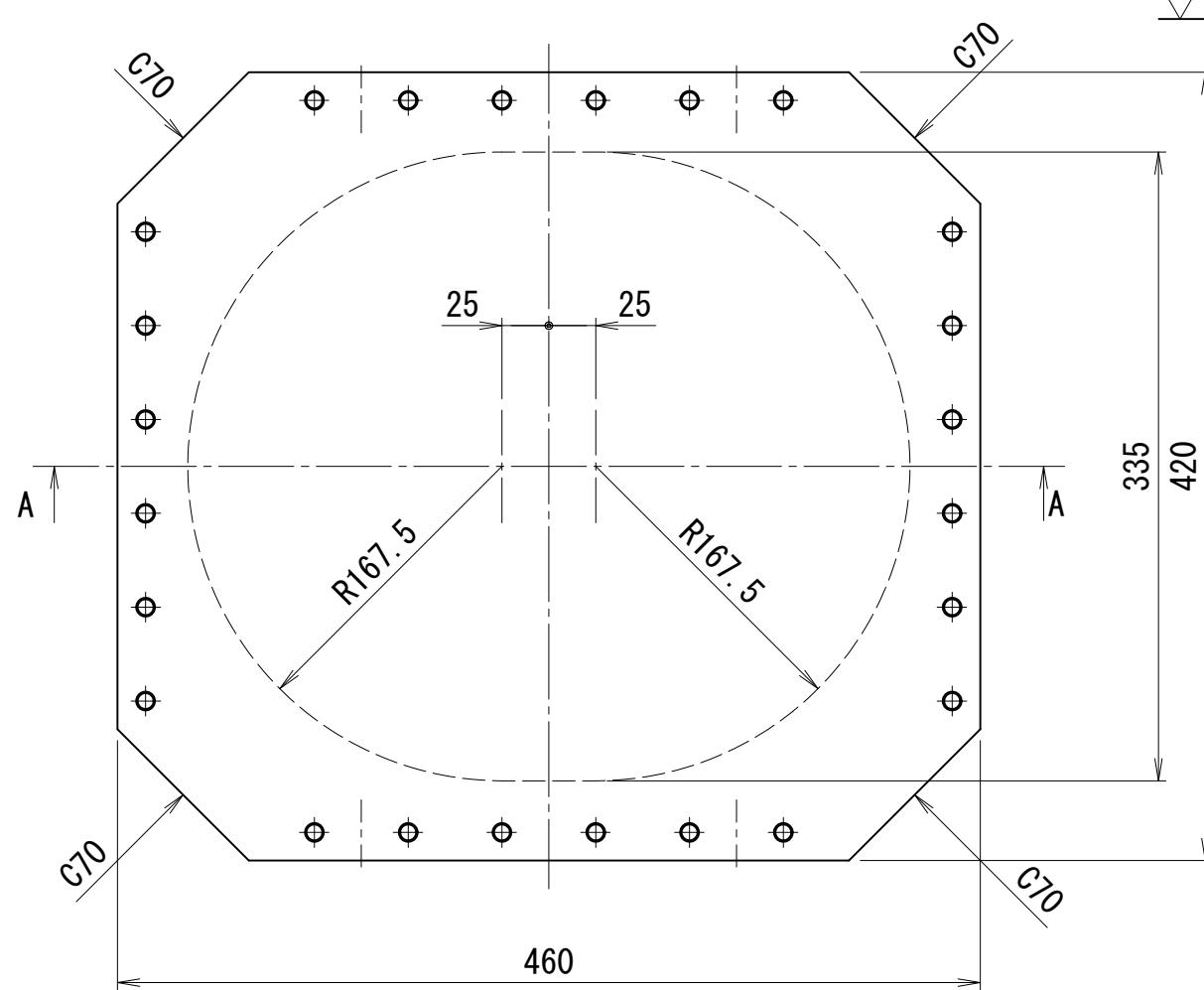
2000kN30ストローク補修用油圧ジャッキユニバーサルプレートB
