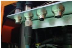
S-BOX は 4 系統の圧力変換器を内蔵し、4 個の変位センサを接続することが出来ます。更に電動ポンプの制御出力にも対応している為、新たにローカルユニットを用意する必要が無く、機材の簡略化に寄与します。
